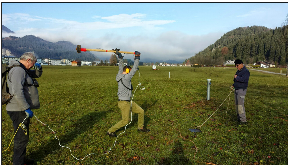
Abb. 2 Seismische Anregung mit einem 6 kg Hammer, mit dem auf eine Stahlplatte geschlagen wird. Die Energie mit dieser Quelle ist ausreichend für die Erfassung von geologischen Strukturen bis in Tiefen von 3 – 400 m. Der Schlagtrupp befindet sich hier auf dem Profil 1 bei den beiden Sondierbohrungen.
