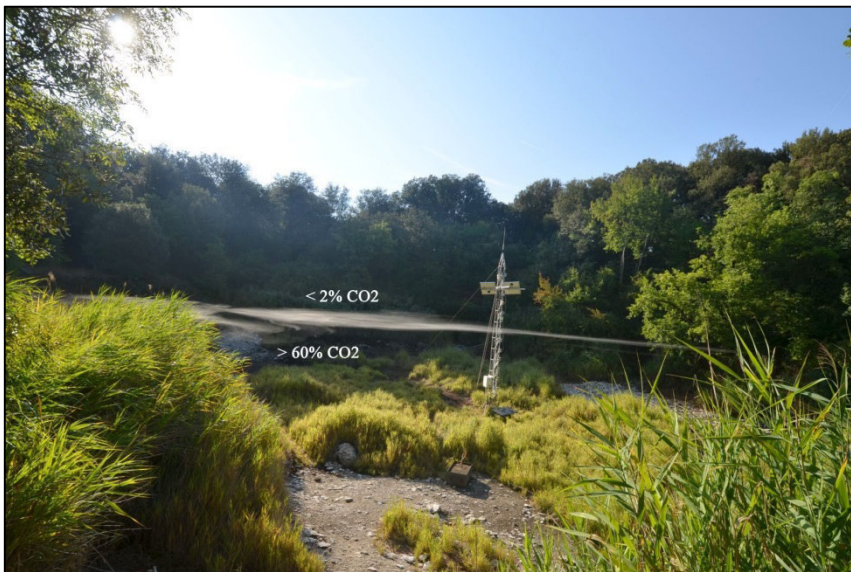
Abb.2. Das Bild (aufgenommen gegen 9 Uhr) zeigt die Mofette bei Rapolano (Toskana) und den Messturm (CO 2 und Temperatur alle 40 cm). Die Wolke bildet sich aus dem im Kohlendioxid-See verdunstetem Wasser das an der See-Oberfläche kondensiert; hier findet auch ein abrupter Temperatursprung statt
