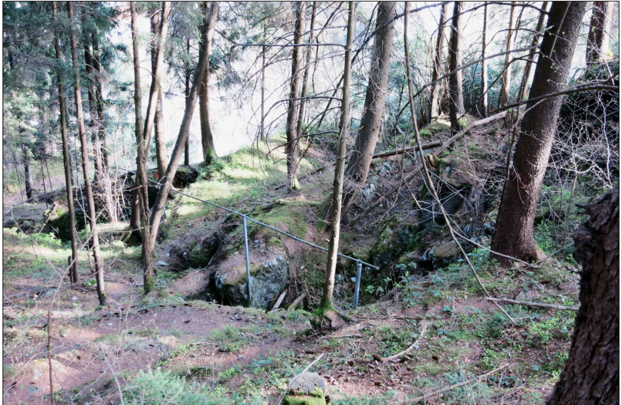
Abb. 4: Westrand der Massenbewegung Maria Rast mit Extensometerrohr 4
